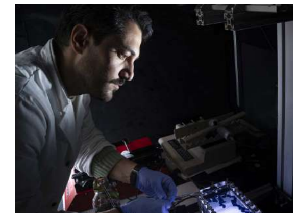
Étude du déplacement d'une phase aqueuse par du CO 2 injecté dans un modèle de fracture géologique.
