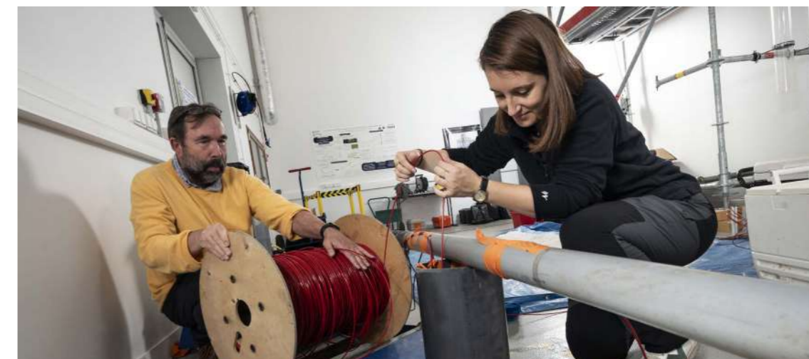
Tests instrumentaux de mesures distribuées de température, pôle Eau souterraine de l'OSERen.
