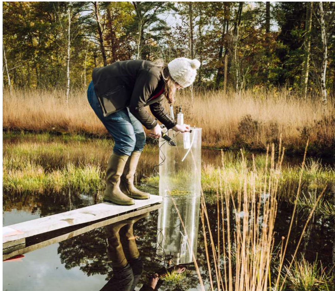
Mesure des flux gazeux de carbone sur un dispositif expérimental, tourbière de la Guette.
