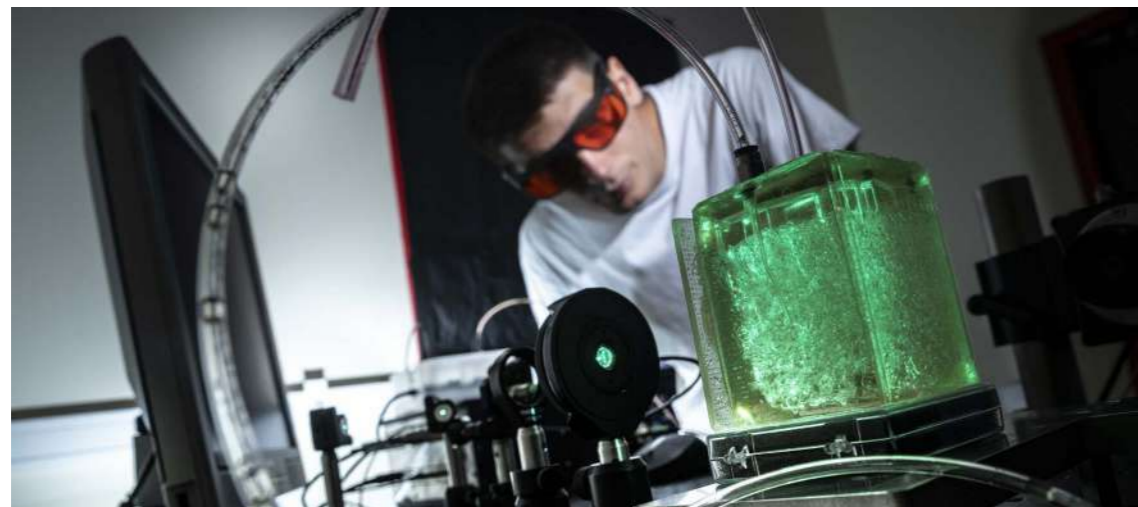
Modèle 3D d'un réseau vasculaire cérébral de souris placé sur une table optique pour y injecter un laser.
